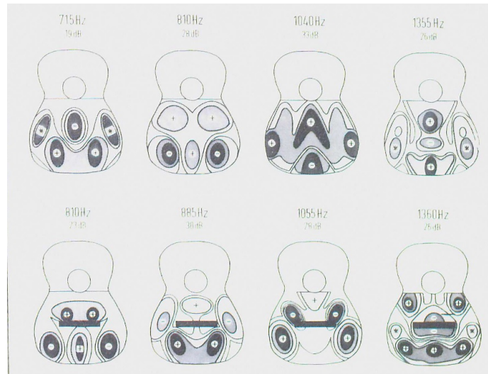
Abbildung 2.4: Schwingungsbilder bei den Resonanzfrequenzen der Decke. Die Graustufen entsprechen jeweils 4dB. Flächen mit gleichem Vorzeichen schwingen gleichphasig, der Stern deutet eine Phasenverschiebung von 90 Grad an, untere Abbildung mit Steg.
