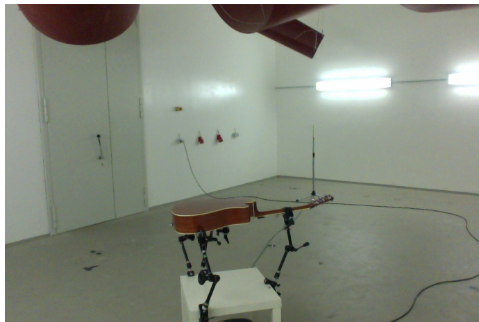
Abbildung 6.7: Messaufbau im Hallraum
