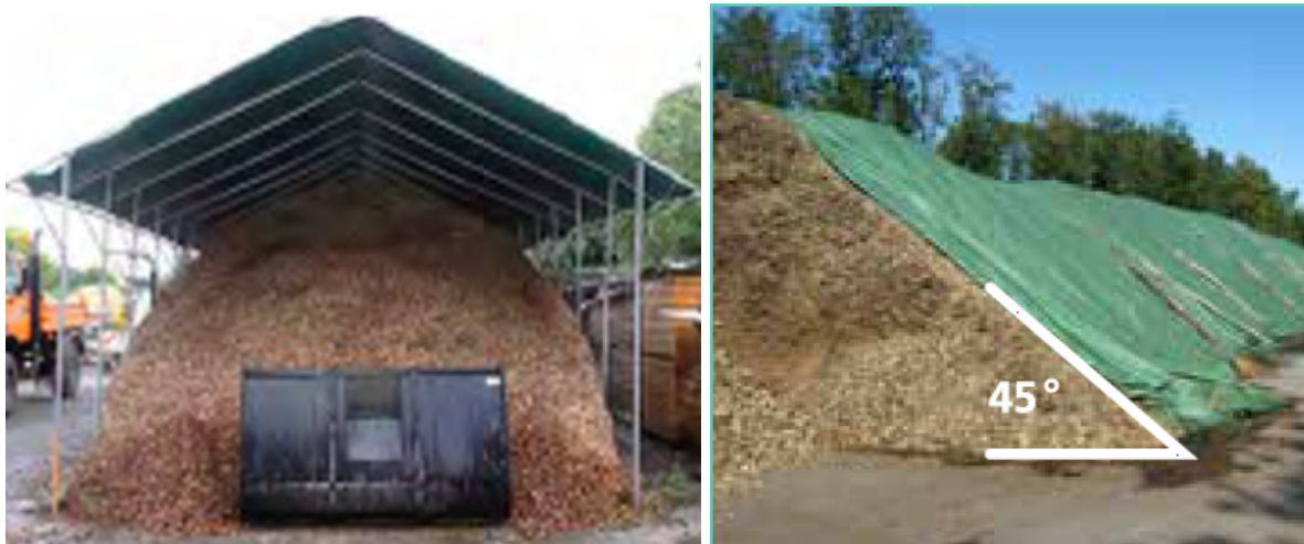
Abb. 11.: Beispiele für Jahresbrennstofflager (links: Regenschutz mittels Überdach, rechts: Abdeckung mit diffusionsoffenen Vliesen) 12
