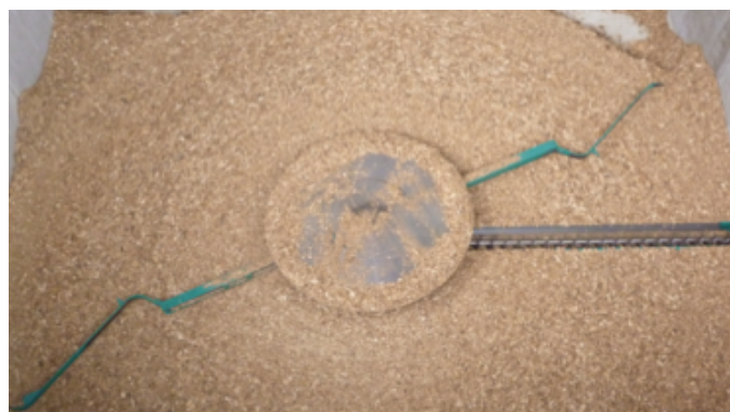
Abb. 12.: Brennstoffbunker mit Austragungsschnecke 13
