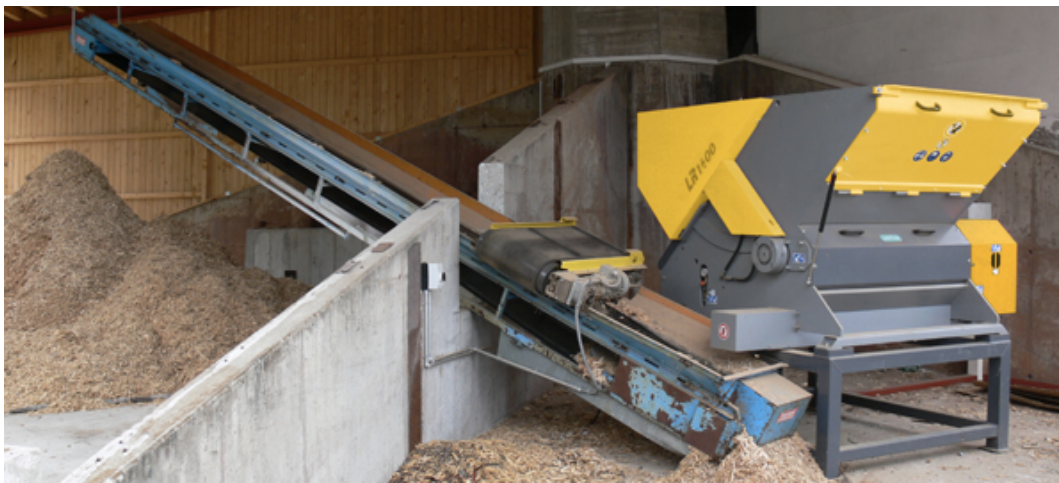
Abb. 10.: Untha LR 1000 zur Restholzerkleinerung 12
