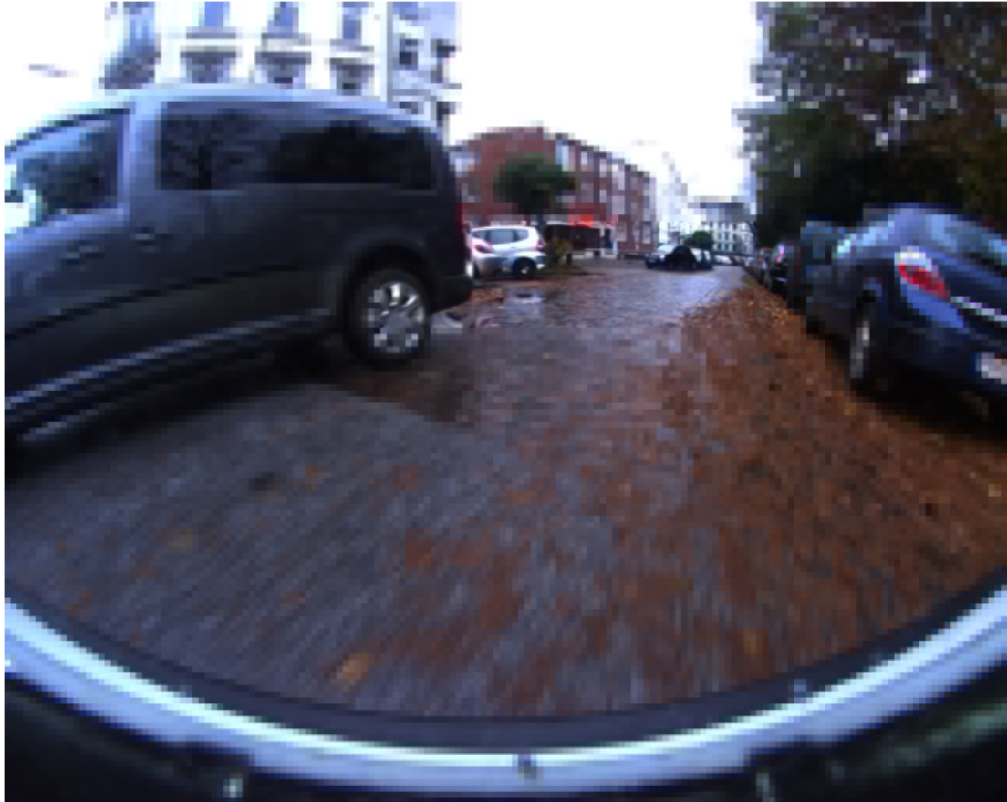
Abbildung 7.5: Beispielbild von ROI Kompressionsverfahren Zwei mit einer ROI Größe von 5% und niedrigster Hintergrundqualität.
