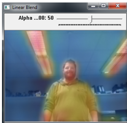
Abbildung 3.9: Prozentsatz der Überblendung IR/sichtbar beträgt 50% IR/50% sichtbar.
