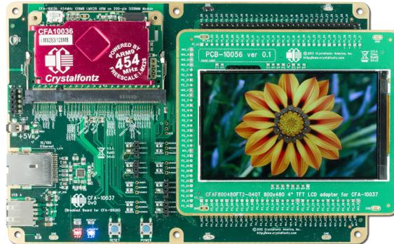
Abbildung 3.12: LCD-Modul auf Carrier-Board und Development-Board
