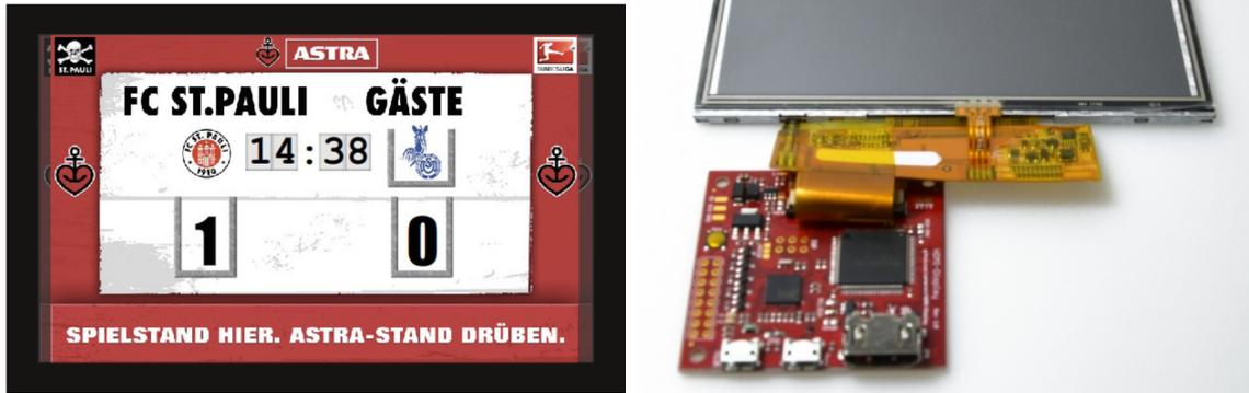
Abbildung 3.13: Skizze und Abbildung des LCD-Modul von *watterott.com*
