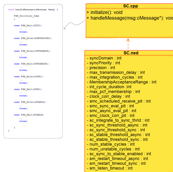
Abbildung 4.3.: SC - UML Diagramm (nach dem OMNeT++ Mechanismus implementiert)
