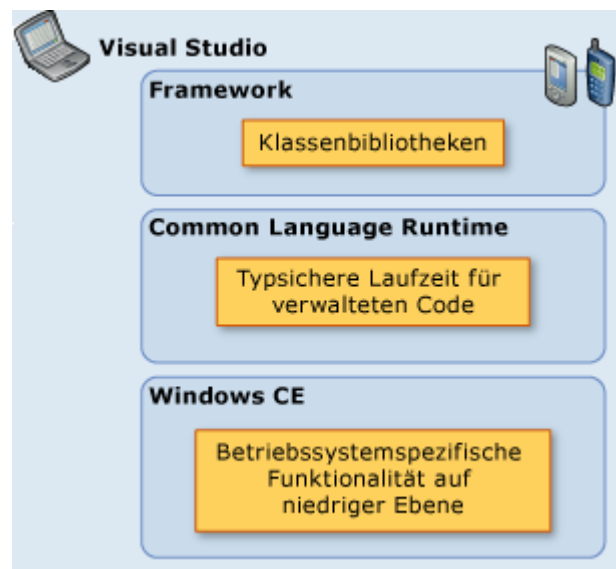
Abb. 2.1: .Net Compact Framework Architektur [MS-NET A 2007]
