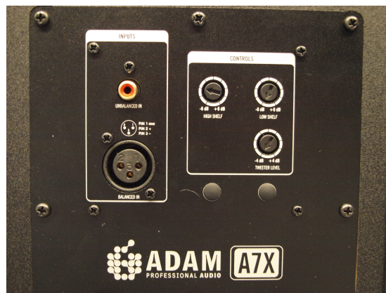
Abbildung 8.5: Eingänge und Equalizer der Adam A7x Lautsprecher
