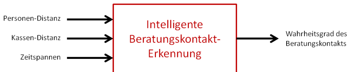
Abbildung 9: Blackbox Funktionsblock der intelligenten Beratungskontakterkennung
