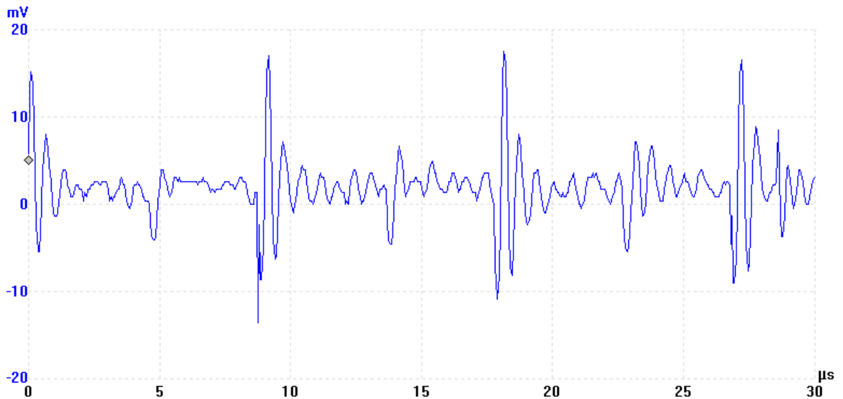
Abbildung 5.1: Das Rauschen des Gyroskops mit einem Oszilloskop gemessen
