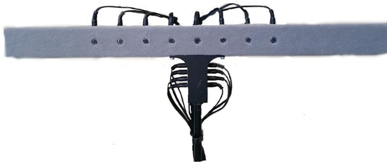
Abbildung 4.6.: Mikrofonarray
