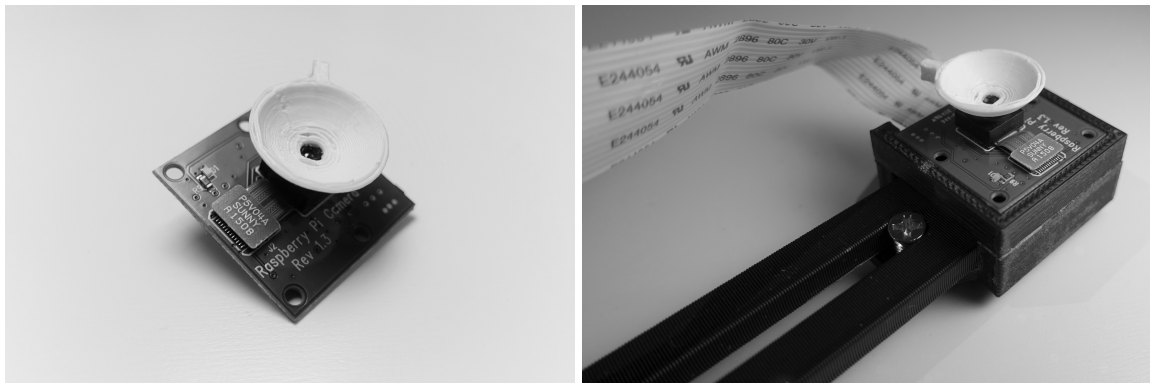
(a) Kameramodul mit Fokusring
