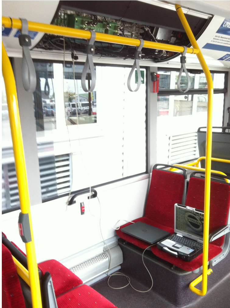
Abbildung 3.2.: Messaufbau im Batteriebus Solaris Urbino 18,75
