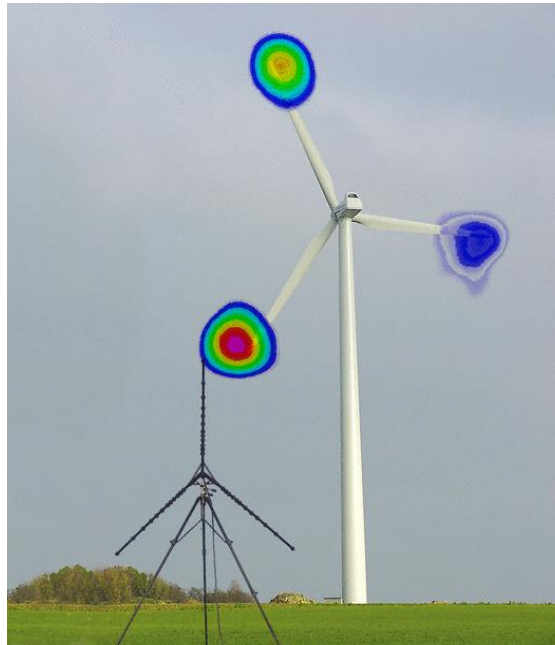
Abbildung 1: Akustische Messung an einer WEA [1]
