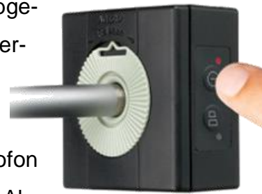
Abbildung 39: Mikrofon wird kalibriert
