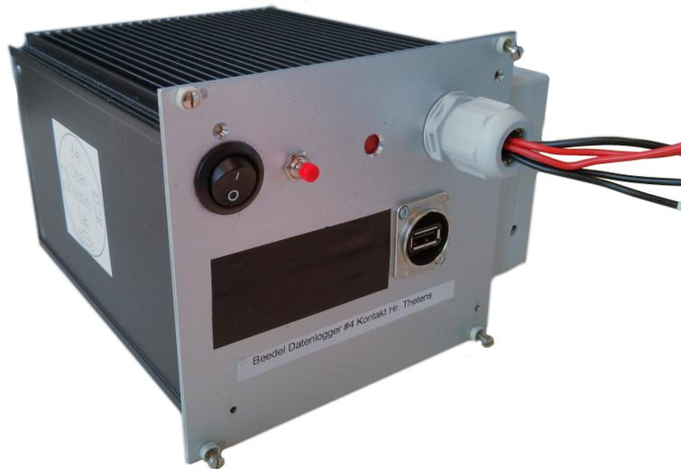
Abbildung 5.1.: Client: BEEDeL Datenlogger für Nahverkehrsbusse
