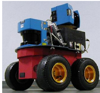
Abbildung 1.2.: Ein Pioneer III Roboter mit 2 SICK-Laserscannern zur 3D-Kartierung.
