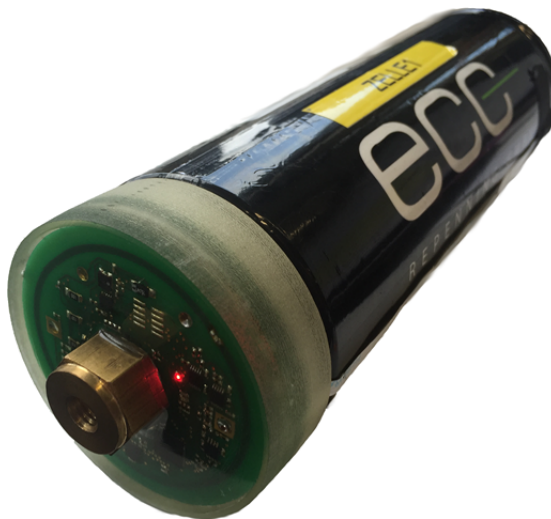
Abbildung G.2.: Montierter und vergossener Zellsensor auf einer ECC-LFPP 45Ah LiFePO 4 -Zelle
