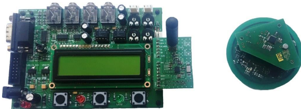
Abbildung 3.1.: Batteriesteuergerät mit CC1101-Transceiver Platine und Zellsensor der Klasse 3 mit hochauflösender AD-Wandler Erweiterungsplatine
