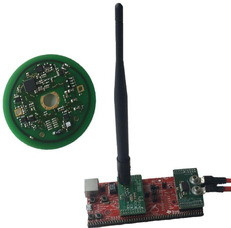
Abbildung 6.1.: Neu entwickeltes Messsystem mit Batteriesteuergerät und Zellsensor
