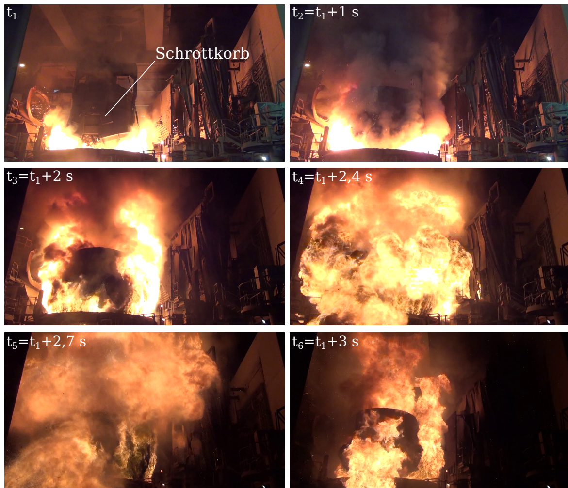
Abbildung 3.1.: Rauchgasbildung beim Setzen des Schrottkorbes; von l.o. nach r.u.: (1) - (6)
