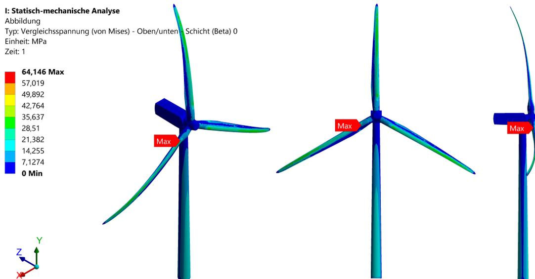
Abbildung 29: Statische Analyse aufgrund Einzellast von 80 kN an den Rotorblattspitzen mit einem Überhöhungsfaktor von 2,6
