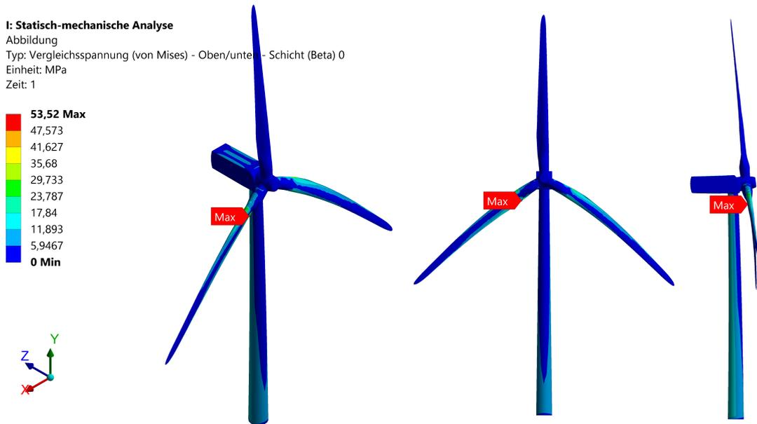
Abbildung 27: Statische Analyse aufgrund Eigengewicht mit einem Überhöhungsfaktor von 25
