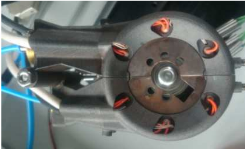
Abbildung 26: Schalen mit Heizpatronen und Temperatursensoren
