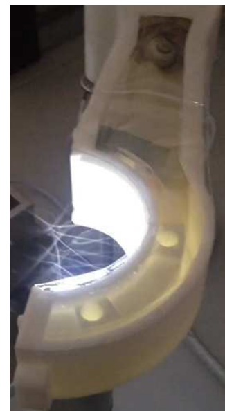
Abbildung 70: Heizsystem mit Piezo und Testaufbau für Befeuchtung
