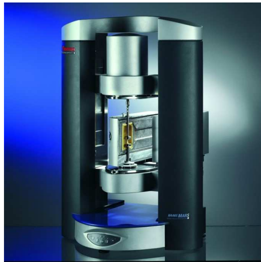
Abbildung 3: Rheometer mit einer handelsüblichen Heizvorrichtung [9]
