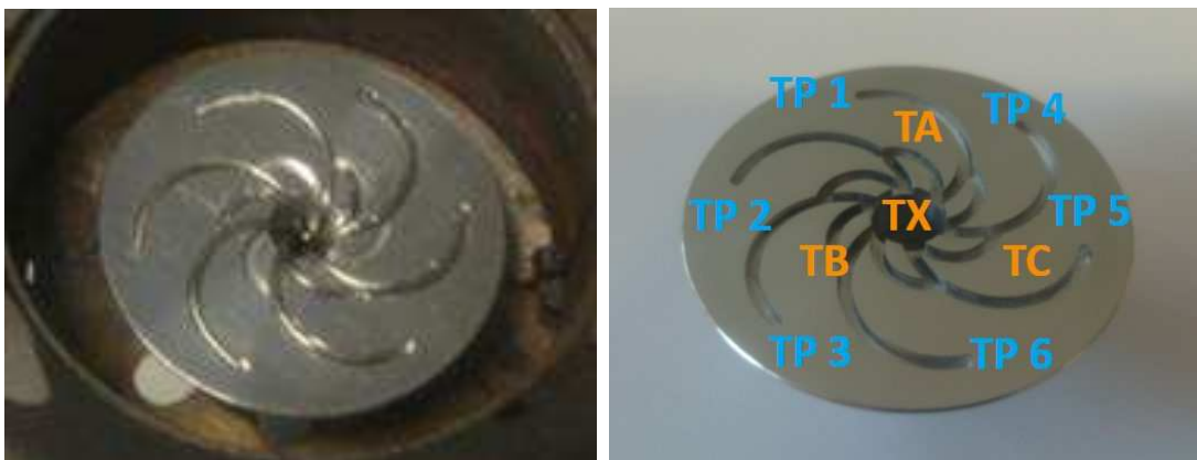
Abbildung 45: Probenträger mit Thermoelementen (l.), Probenträger mit Nomenklatur (r.)
