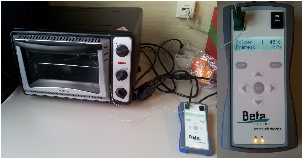
Abbildung A.13.: Reflow-Ofen (links) mit temperaturgesteuertem Netzregler (rechts)
