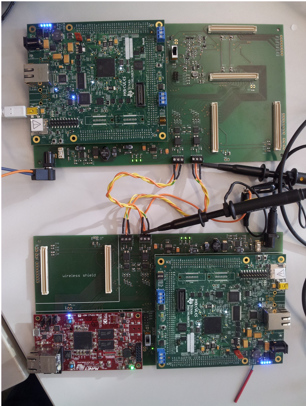
Abbildung 6.1.: Foto des Messaufbaus für die drahtgebundene FlexRay-Datenkommunikation
