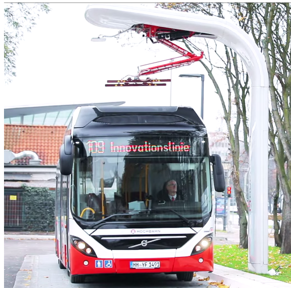
Abbildung 1.1.: Nahverkehrsbus beim Nachladen an der Ladestation der Innovationslinie 109 am Hamburger ZOB [7]
