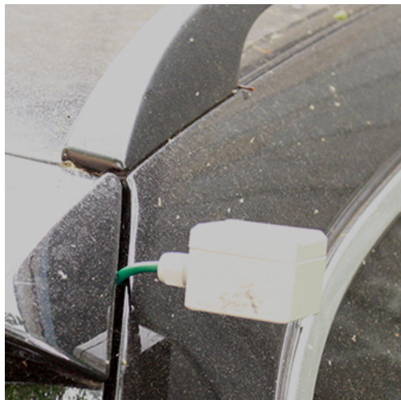
Abbildung C.2.: Einbau der GNSS-Empfängers während der Messungen im PKW, Beispiel: Rechte Fahrzeugseite
