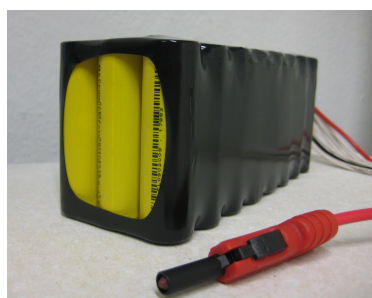
Abbildung 1.1.: 8s3p-Akkublock bestehend aus 18650-Zellen
