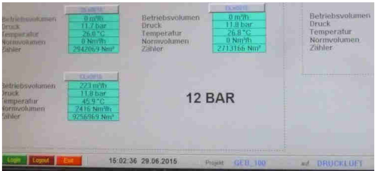
Abb. 22 : Umgebungstemperaturen von K14, K15 und K16 (in Betrieb); die Lufttemperatur beträgt ca. 26,2 °C (gemessen um 15 Uhr an der Station München-Stadt) (ÖKOTEC Energiemanagement GmbH 2014a)
