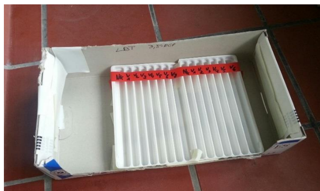
Abbildung 15: Pipettierhilfe zur einfacheren Belegung der Mikrotiterplatte
