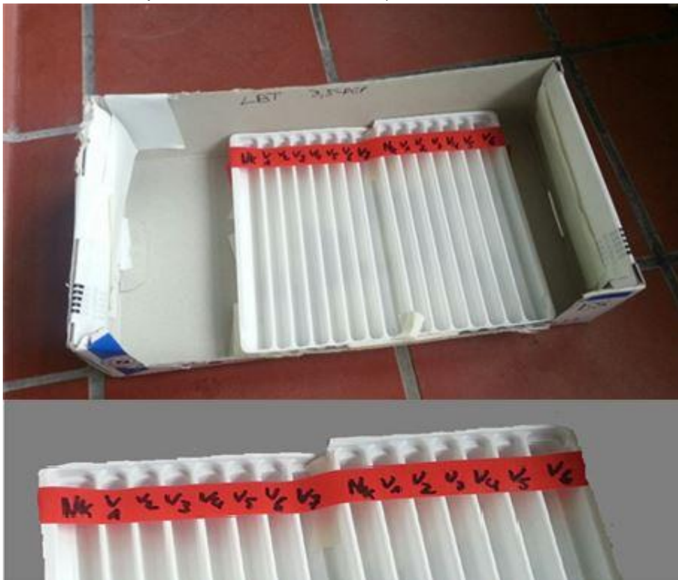
Abbildung 6: Pipettierhilfe zur Belegung der Mikrotiterplatte
