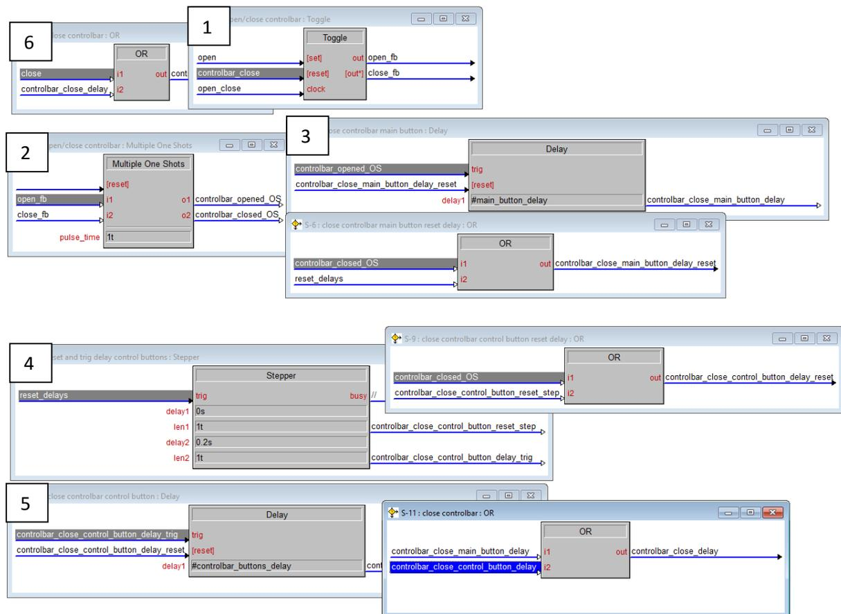
Abbildung 4.15: Simpl-Windows-Modul für Logik der Lautstärkeregleisleiste
