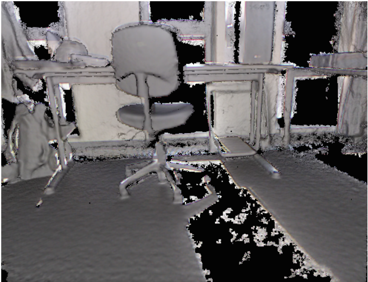
Abbildung 5.2: Löcher in der Punktwolke, durch Sonnenlicht und Fenster
