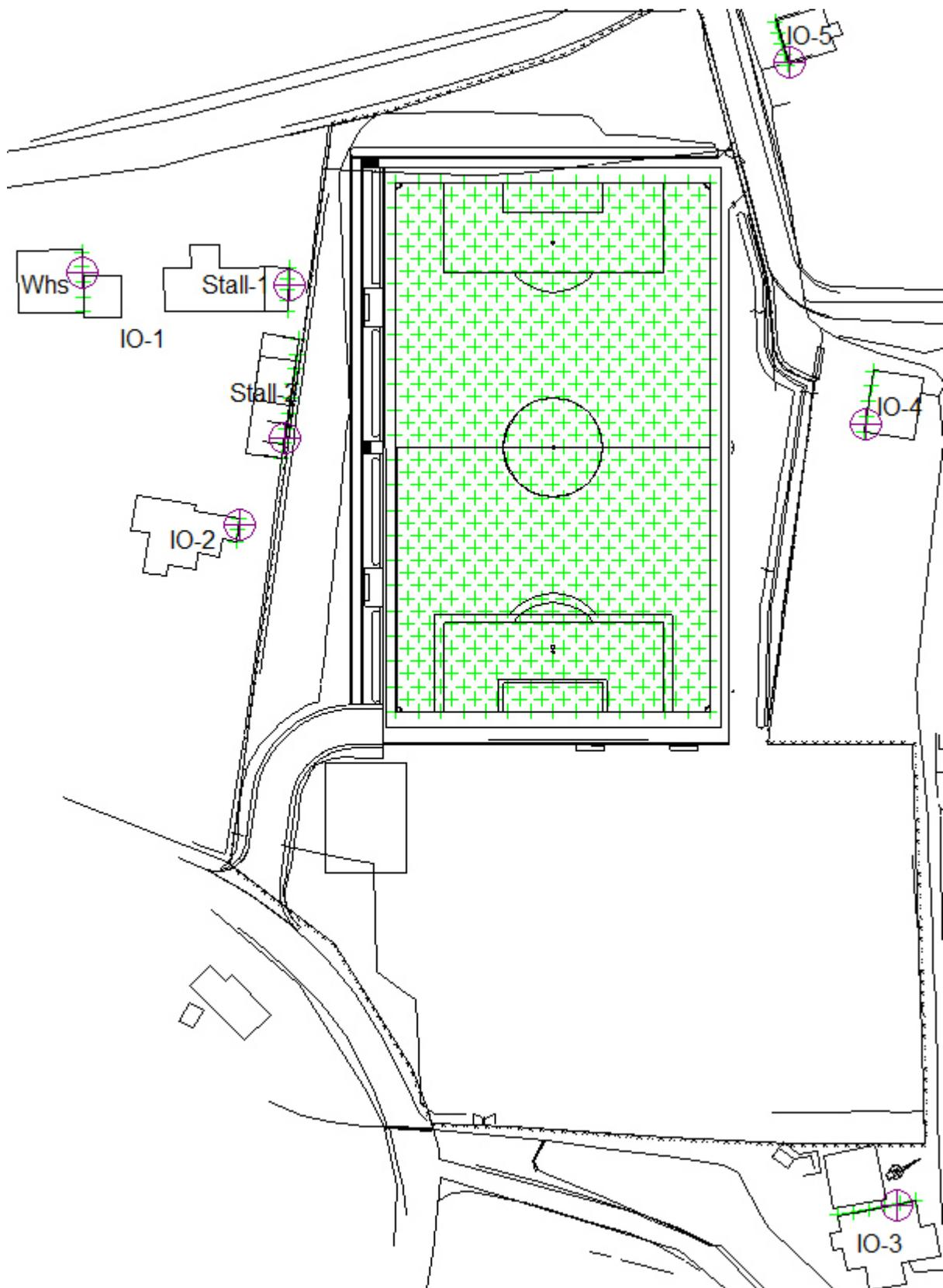
Abbildung 30 Plan Sportplatzbeleuchtung (Philips Lighting GmbH)
