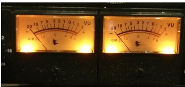
Abbildung 3.4: Anzeige der VU-Meter des API 2500 Stereo Compressor
