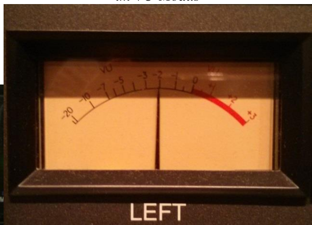
Abbildung 3.3: Anzeige des DK-Audio MSD100T im VU-Modus
