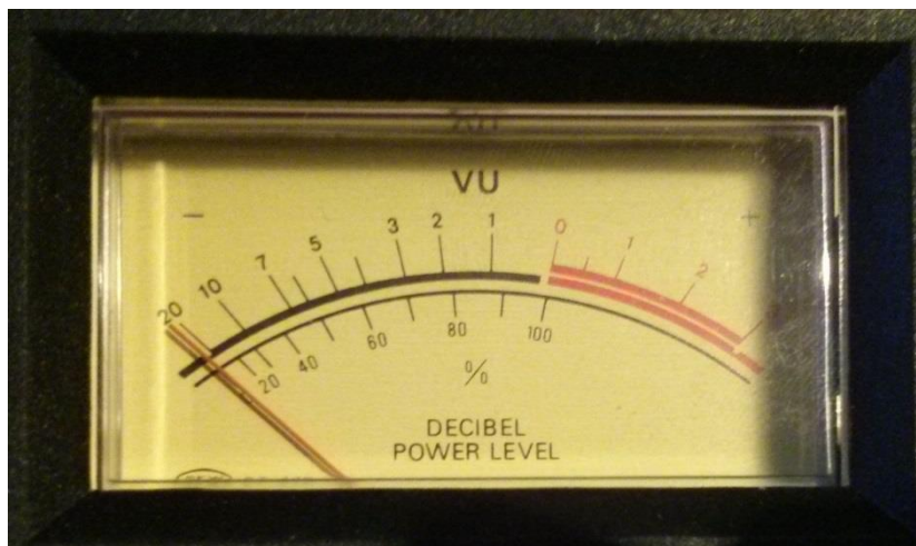
Abbildung 3.1: Anzeige des beim selbstmontierten VU-Meter verwendeten SEW ST-745
