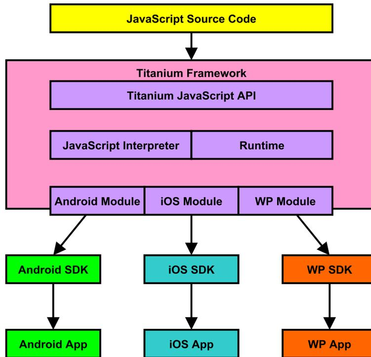
**Abbildung 4.6:** Ablauf des Titanium Interpreters von Appcelerator
