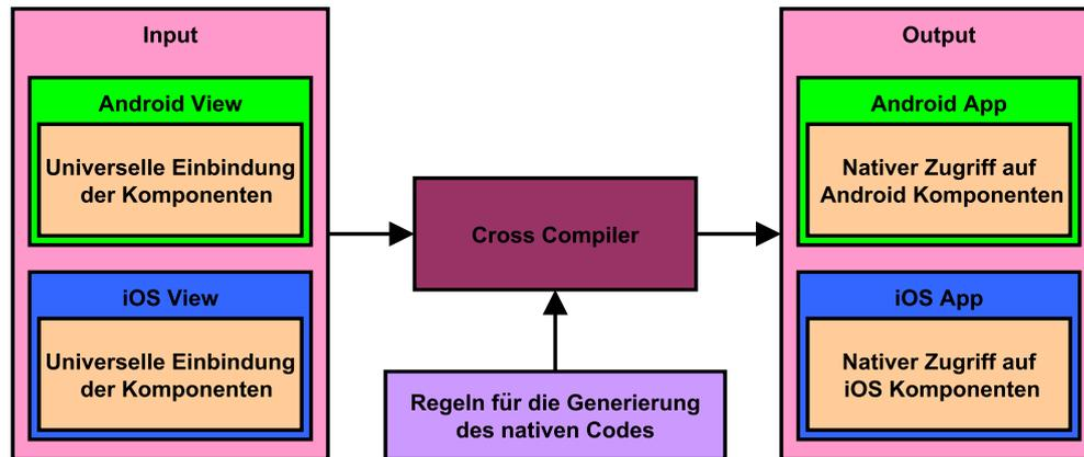
**Abbildung 4.8:** Funktion eines komponentenbasierten Mergeansatz
