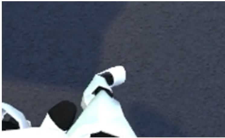
Abbildung 5.2: Fuß versinkt in den Boden bei deaktivierter "ground constrain"
