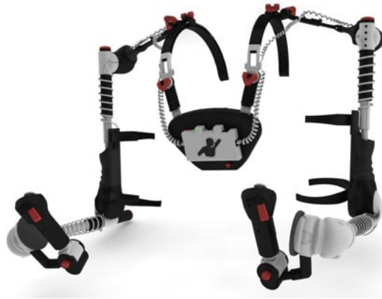
Abbildung 2.3: mechanischer MoCap-Anzug "Gypsy 7" der Firma "Meta Motion"
