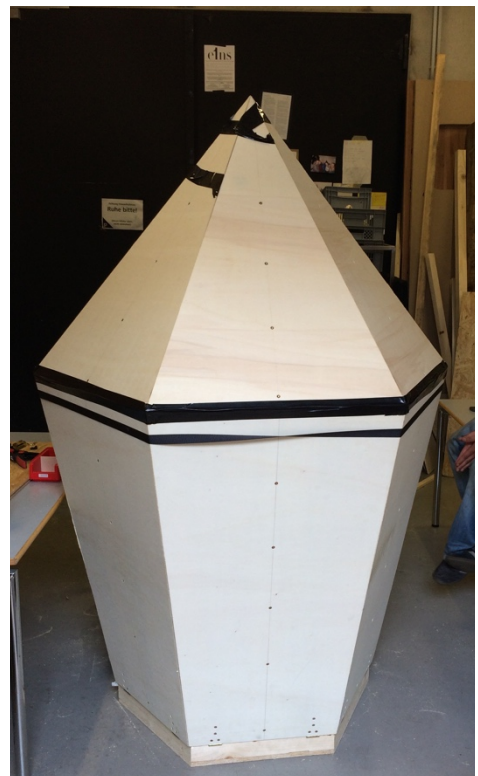
Abbildung 24: Holzkorpus ohne Innenlebe, mit Spanngurt und Klebeband fixiert
