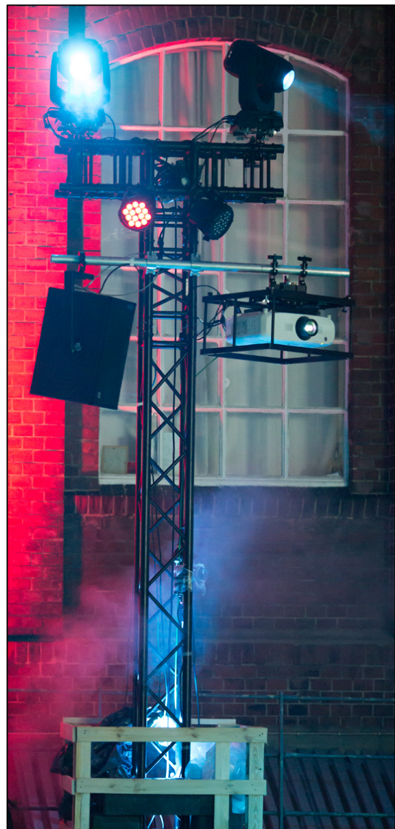
Abbildung 38: Traversenturm mit Projektor, Scheinwerfern und Lautsprecher
