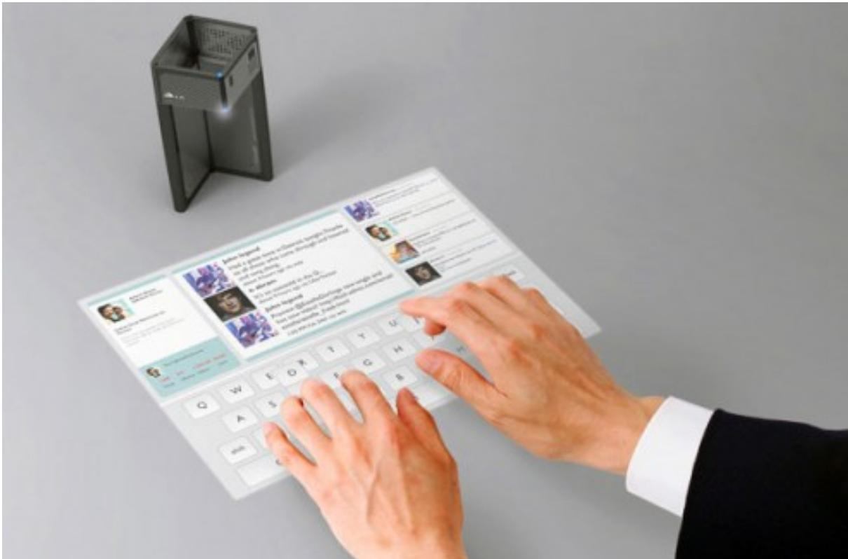
Abbildung 2.2. - Ein Mini-Projektor und ein Trackingsystem ersetzen ein Touchdisplay.
