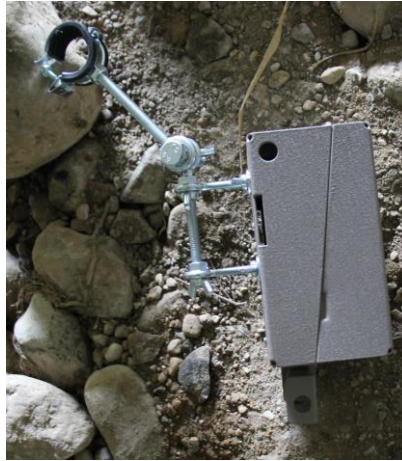
Abb. 13 Winkelverstellbare Gelenkhalterung am Stahlgehäuse
