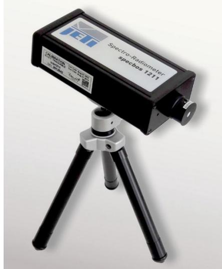
Abbildung 18: Jeti Spektralradiometer Jeti specbos 1211
