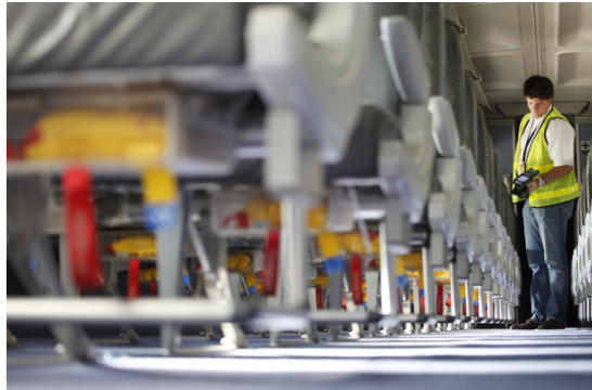
Abbildung 2.1.: Preflight-Checks mittels RFID-markierter Ausrüstung [RFI13]
