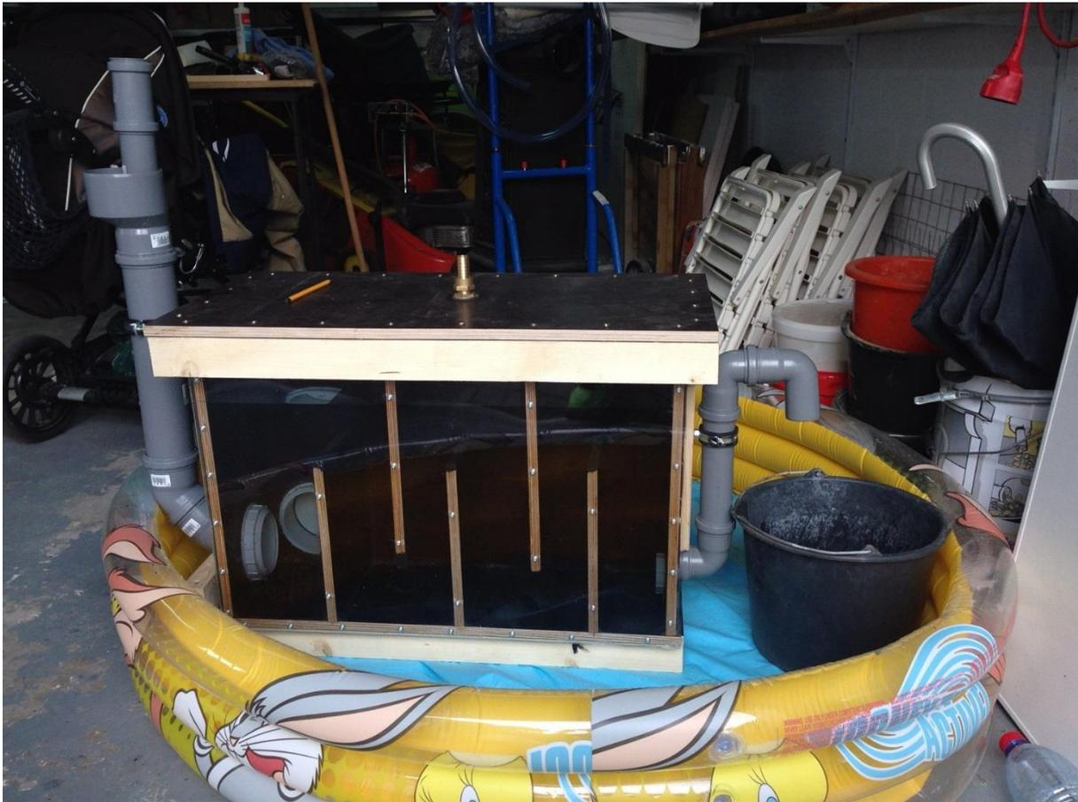
*Abbildung 20: Foto Prototyp II - fertige Anlage mit Wasser gefüllt*
