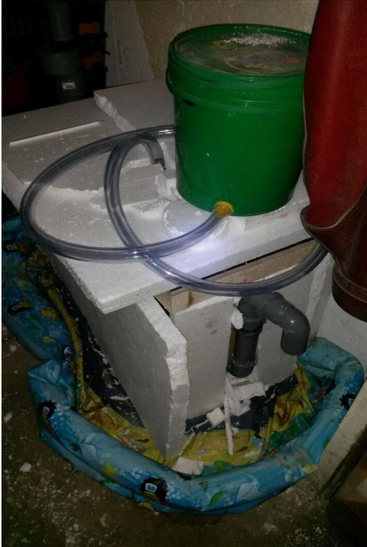
Abbildung 22: Biogasanlage mit Gasbehälter
