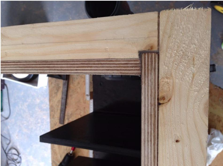
*Abbildung 18: Foto Konstruktion Prototyp II - Nahaufnahme Abdichtung*
