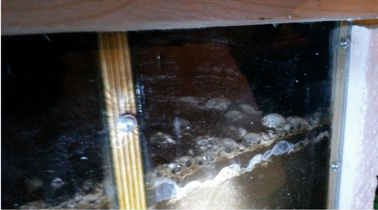
*Abbildung 24: Sicht auf Blasen im Inneren des Fermenters*
