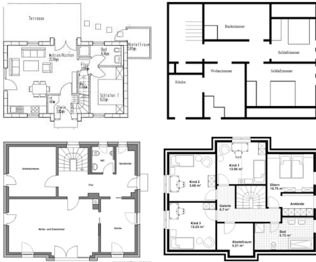
Abbildung 3.1: Beispiele verschiedener Darstellungsformen von Grundrissen
