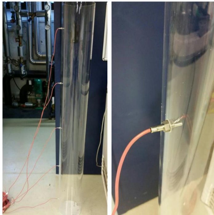
Abbildung 7: Die erste Zelle mit den montierten fünf Temperatursensoren
