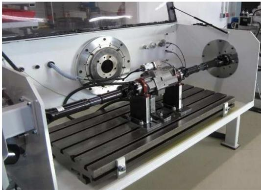
Abbildung 3 Getriebeprüfstand der Firma Jetschke (aus [17])
