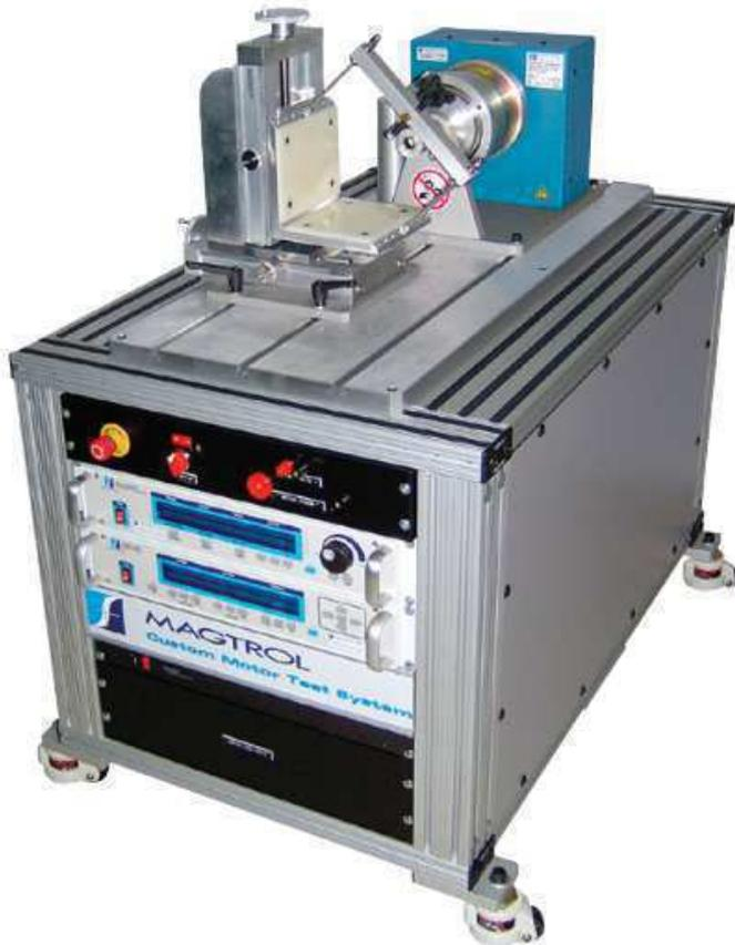
Abbildung 9 Motorenprüfstand der Firma Magtrol (aus[22])
