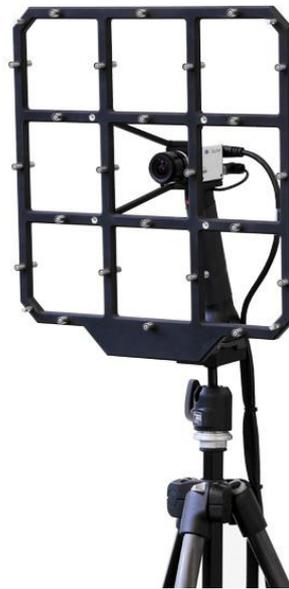
Abbildung 3-1: Akustische Kamera - Paddle 2x24 AC Pro - Akustische Kamera für Nahfeldanalysen [GFA2015]
