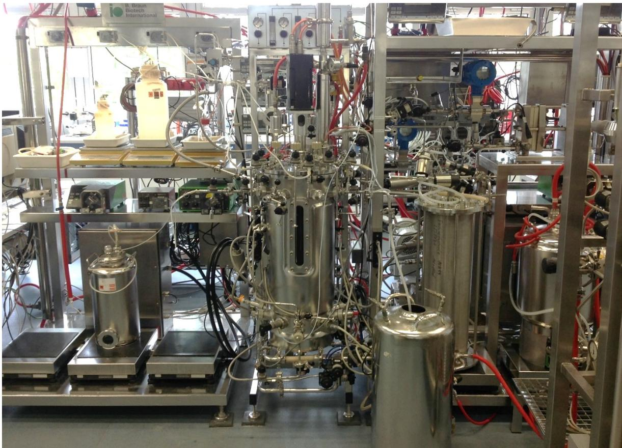
Abbildung 6: Instrumentierung Biostat C30 und Geräteperipherie.
