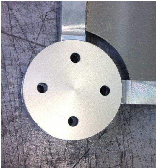
Abb. 4-7: Knotenscheibe vor dem Bohren und Reiben
