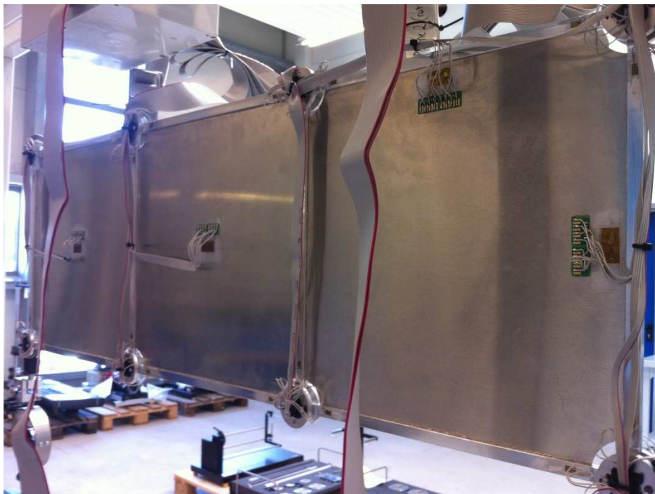
Abb. 4-13: Verbindung der Messstellen mit Flachbandkabeln
