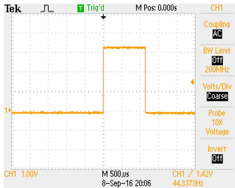
Abbildung 5.1: PPM Signal das der BeagleBone mit PWM für die Lenkung erzeugt.
