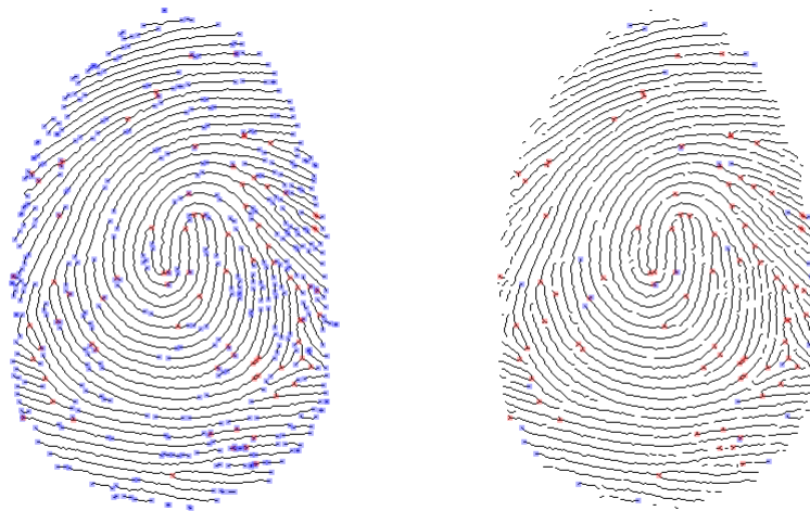
(a) Erkannte Minutien ohne Filterung (b) Erkannte Minutien mit Filterung
