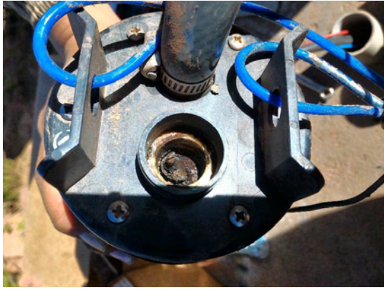
Abb. 18: Durch Wassereintritt beschädigte Pumpe [Energética]
