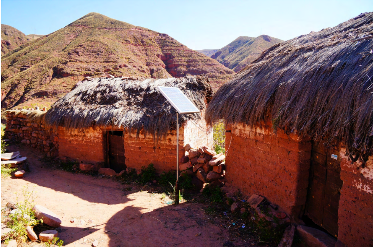
Abb. 17: Modul mit zu steilem Neigungswinkel und Verschattung im Tagesgang
