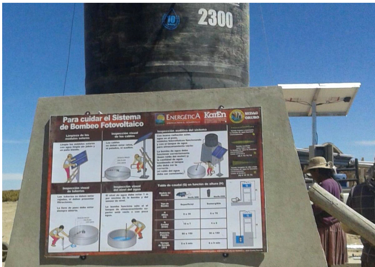
Abb. 34: Informationstafel mit den wichtigsten Schritten der Systemwartung [Energética]
