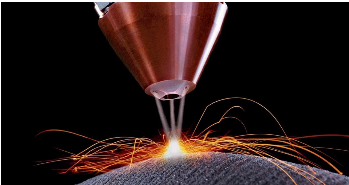
Abbildung 1 Laser-Pulver-Auftragschweißen [Firma Trumpf]
