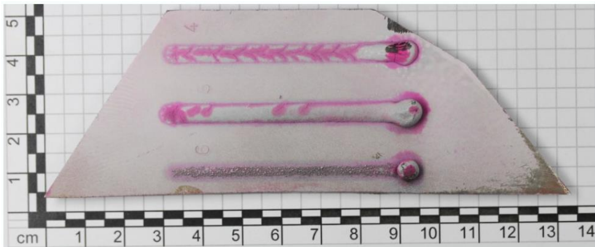
Abbildung 9 Rissdetektierung nach Farbeindringverfahren [LZN Hamburg]
