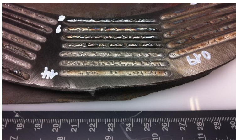
Abbildung 59 Auftragsnähte mit dem Pulverwerkstoff INVAR®
