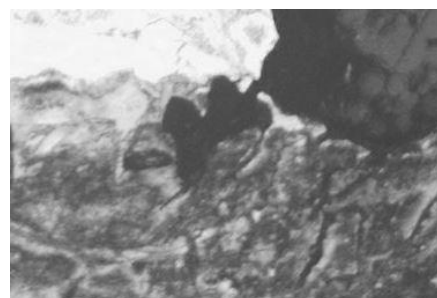
Abbildung 54 Riss in der Randschicht
