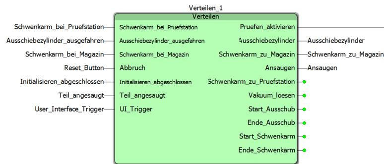
Abbildung 5.1.: Funktionsbaustein Verteilen
