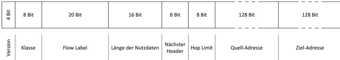
Abbildung 3.4.: Aufbau *IPv6*-Header
