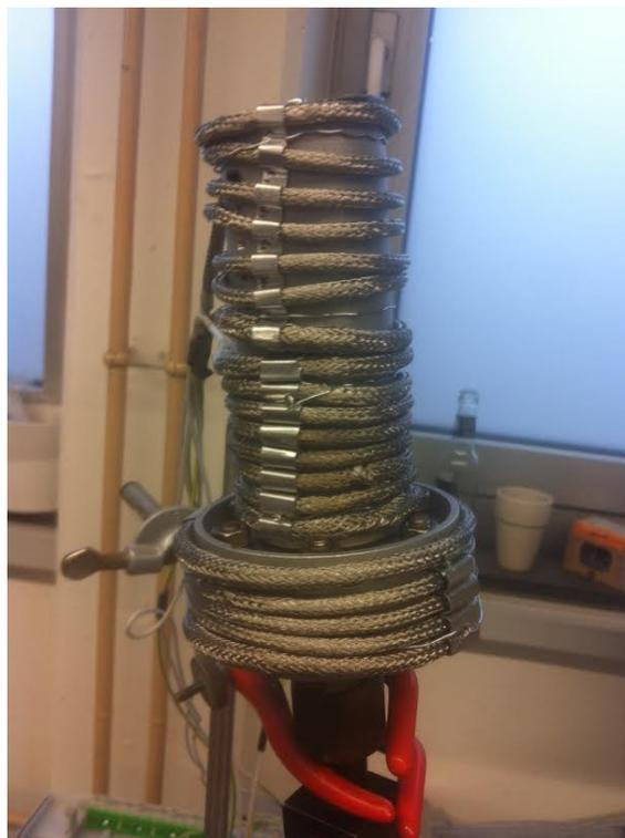
Abbildung 3.5 – Hülsen an denen die Begleitheizungen angebracht sind
