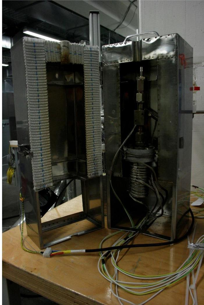
Abbildung 3.3 – Wärmedämmkassette des Wärmerohres
